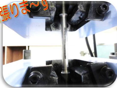
試験材料を試験機にセットします
