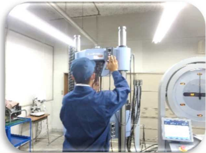
試験材料を試験機にセットします
