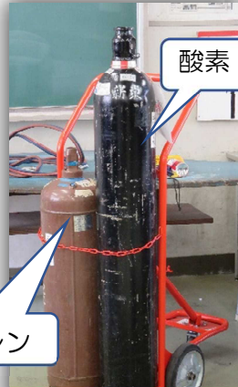
酸素とアセチレンの混合ガスを使います。
